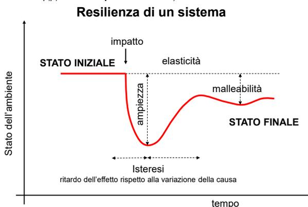
Fig. 2. Curva a sacco di un processo di degrado e recupero (resilienza) della qualità di un corso d'acqua sottoposto a stress (modificato da Galassi *et al.*, 2014).
